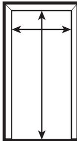
Si la abertura tiene menos de 80" de alto: Una los paneles de la puerta, asegúrelos con cinta de enmascarar y córtelos con una sierra de mano o con una sierra de dientes finos. Corte la guía superior 1/8" más corta que el ancho de la abertura. Saque la cinta de enmascarar.
